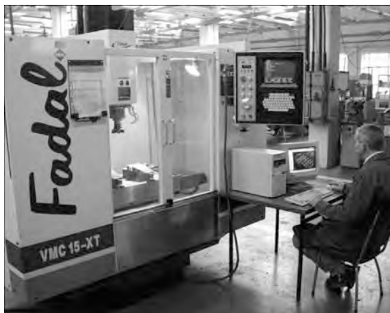
95. Obsługa frezarki sterowanej numerycznie, przy pulpicie mgr inż. Henryk Misiak
