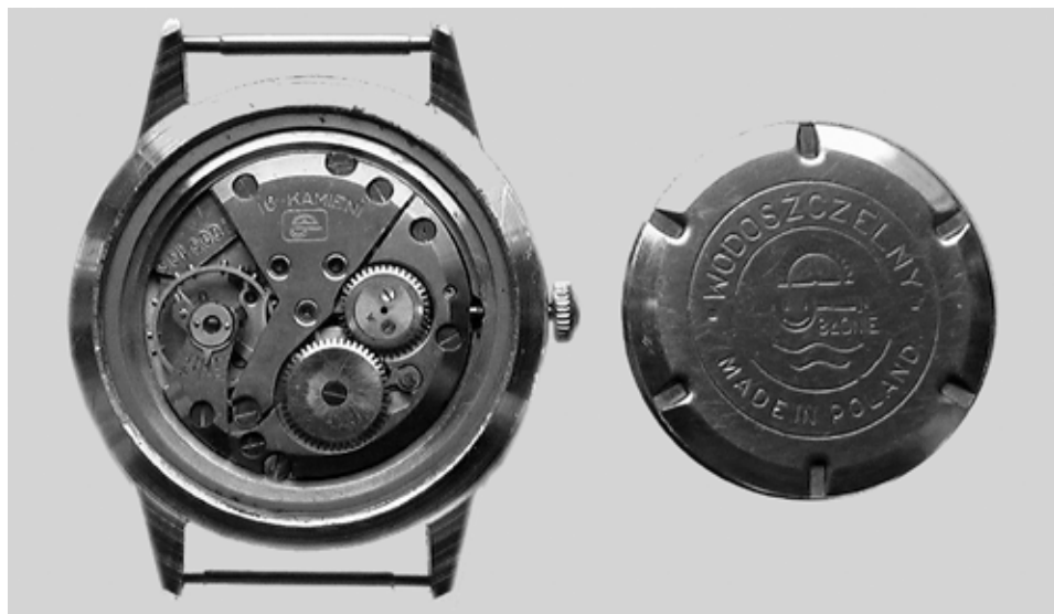
40. Zegarek (z kolekcji Stanisława Kordylewicza) zmontowany z części wyprodukowanych w ZMP, płyta nr 0000106, na mostku przekładni chodu i wieczku koperty znak zakładu
