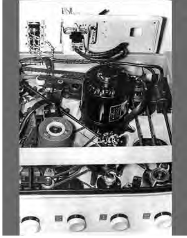
267. Montaż bębna emitera drukarki, Oddział w Siedlcach
